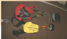
Les deux équipements utilisés pour les sauts tests : la parachute habituel de Luis Cani et le harnais qui reçoit la VX-39 en voile tertiaire.
